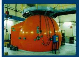
Max neutron flux: 3 10<sup>12</sup> ncm<sup>-2</sup>s<sup>-1</sup>
