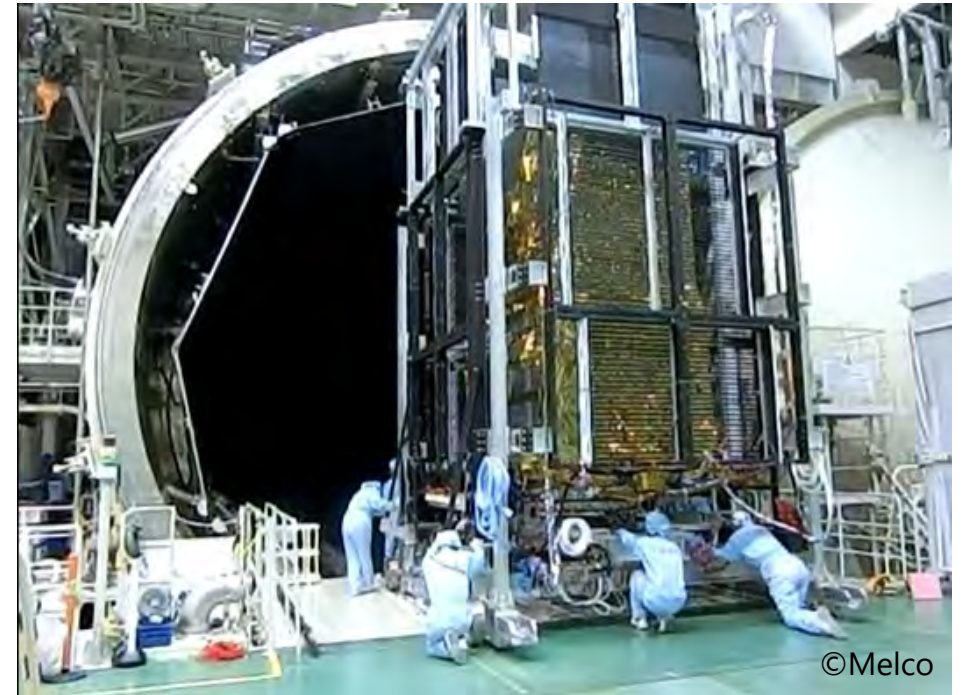
ALOS-4 PFM thermal vacuum test
