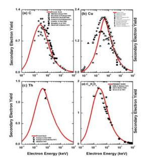
Figure 1. Electron impact SEY of (a) C, (b) Cu, (c) Th and (d)  $C_{10}H_8O_4$ .
