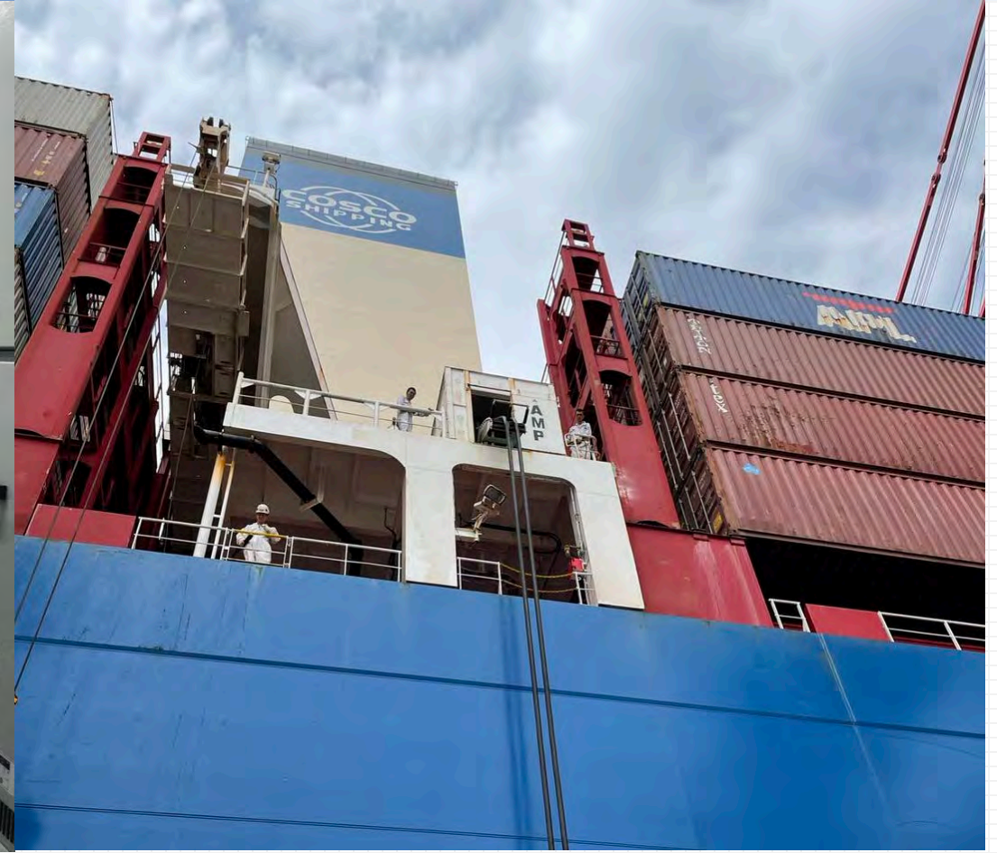
Береговое электроснабжение с возможностью работы на судне
