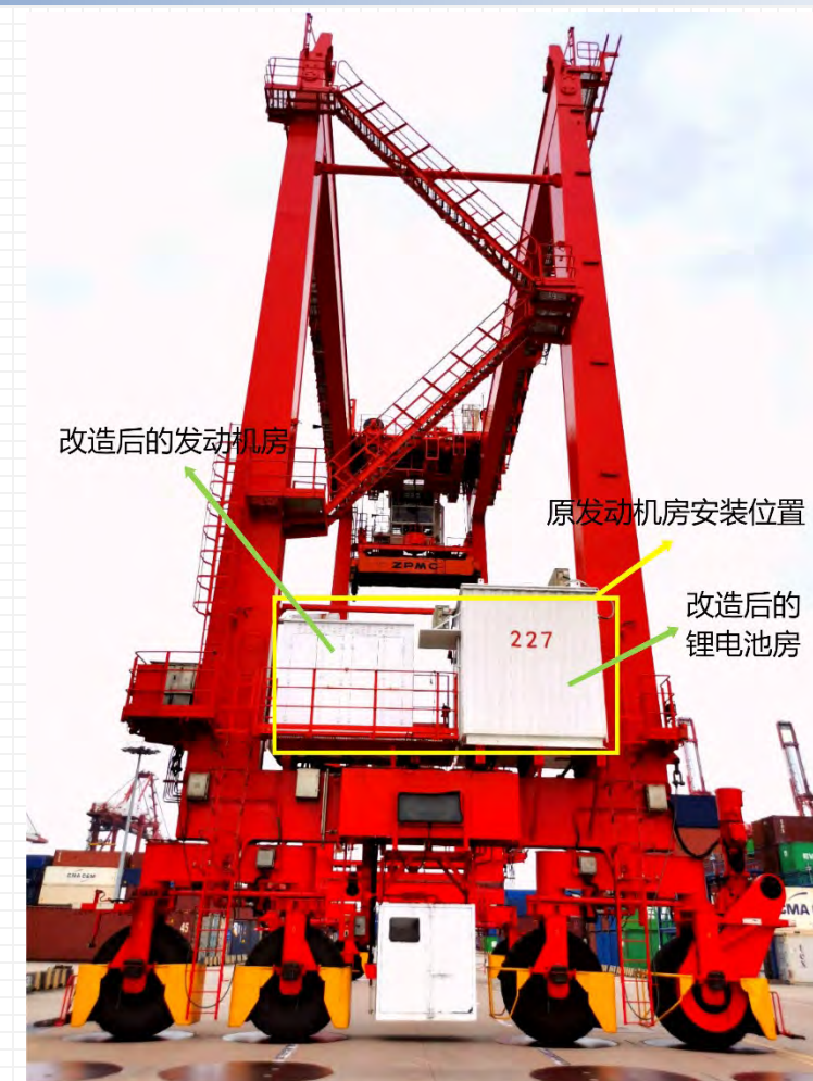
Гибридное преобразование шинного крана в дизельный с литиевой батареей
